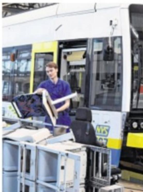
**Ausgebaute Sitze:** Die erste Bahn wird für die Hauptuntersuchung vorbereitet. FOTO: KAWI
